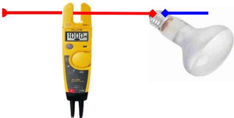
Messen des elektrischen Stromes, mit Zangenamperemeter.
