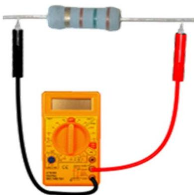
Messen des elektrischen Widerstandes mit Multimeter, parallel zum Widerstand
