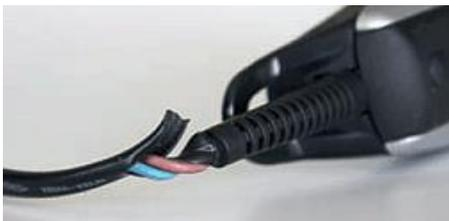
**Am Gerät Kabel verkürzen und neu anschliessen Kann selbst erledigt werden. Gerät muss aber nach den Vorschriften geprüft werden.**
